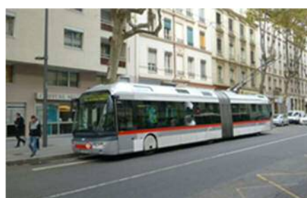
リヨンのトロリーバス。環境に配慮しつつ、輸送能力を高めるため連節構造である。
